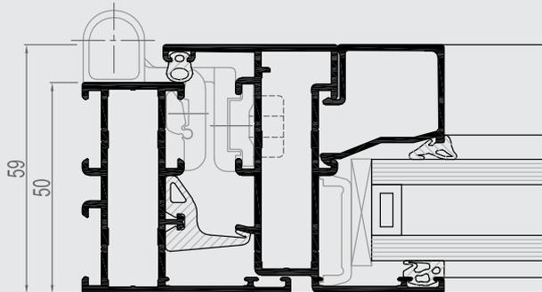
Das Fenster- und Tür-System CS 59Pa ist ein Modul des als „Baukasten“ aufgebauten intelligenten Concept System (CS) von Reynaers. Aufgebaut als thermisch unisoliertes System, findet es vorzugsweise seine Einsatzbereiche im Innenbereich. Es vereint aktuelle Technologie und gute Verarbeitungsmöglichkeiten und stellt somit eine wettbewerbsfähige Lösung dar.
